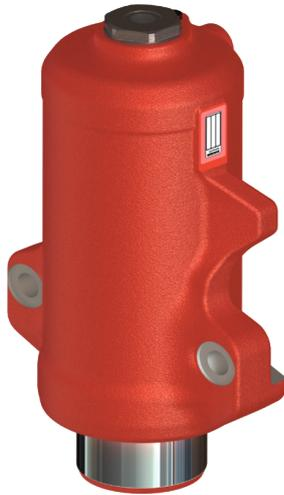
Neue Pendelachszylinder-Generation mit neuem Gehäuse (rechts) von Bucher Hydraulics: Nur noch ein axialer Anschluss vereinfacht die Herstellung, und zwei statt vier Befestigungsschrauben reduzieren den Montageaufwand beim Hersteller der Maschine.
